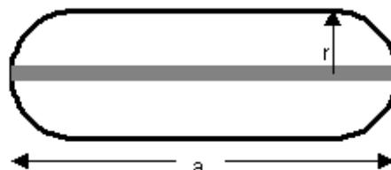
Das Fahrzeug soll mit (betragsmäßig) konstanter Geschwindigkeit  $v$  fahren. Diese wird so gewählt, dass das Fahrzeug gerade noch nicht aus der Kurve fliegt. Hieraus ergibt sich  $v = b \cdot \sqrt{r}$  mit einem festen Faktor  $b > 0$ .
