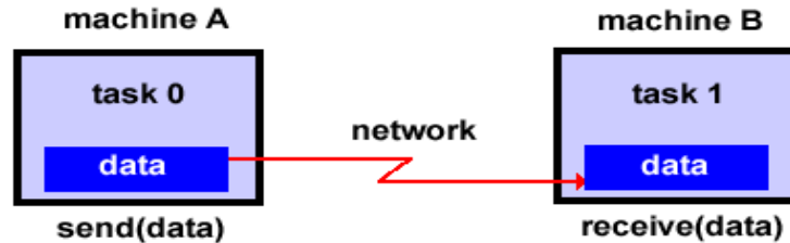
Abbildung 4: Nachrichtenbasierte Interprozesskommunikation (Quelle: https://computing.llnl.gov/tutorials/parallel_comp/images/msg_pass_model.gif )
