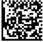
Mit dem Data Matrix Code lassen sich bis zu 1558 Byte mit 8 Bit/Byte, mithin 3116 Ziffern (3,5 Bit) oder 2335 ASCII-Zeichen und Sonderzeichen (erweiterter Zeichensatz 7 Bit) codieren.
